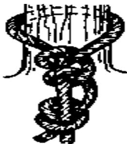
Применяется для крепления веревки к опоре. Узел очень надежный, никогда не затягивается, способен работать под большими нагрузками. Узел «ползет», поэтому необходимо вязать контрольный узел.
